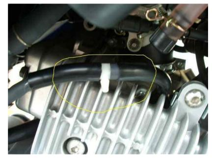
Ahora tenemos que cortar el tubo negro fino que hemos pasado desde el otro lado de la moto, a la medida que nos permita insertarle el codo estabilizador de vacío e insertarlo en la espita que nos sobra de la pieza en forma de T:
